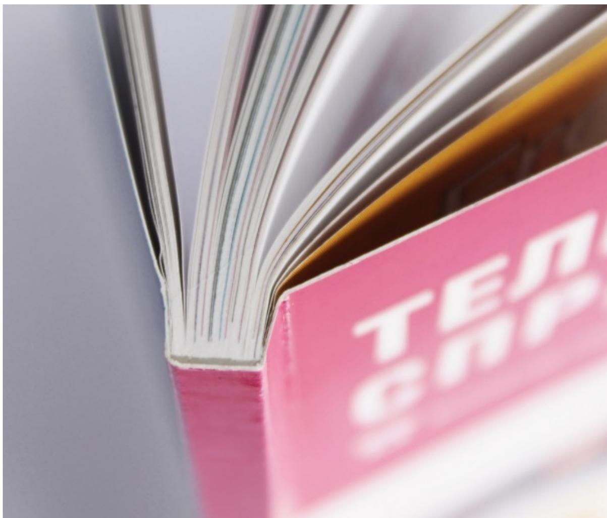
При таком виде переплета обложка приклеивается к книжному блоку. Чтобы клеевое соединение было более крепким, применяется торшенирование – на
